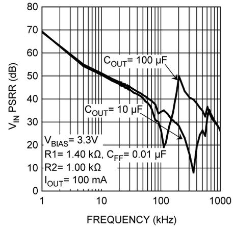
Figure 20.  $V_{IN}$  PSRR
