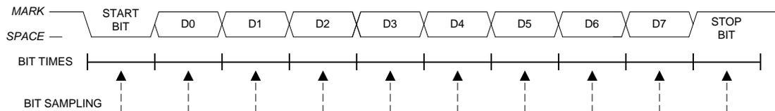
**Figure 17.4. 8-Bit UART Timing Diagram**
