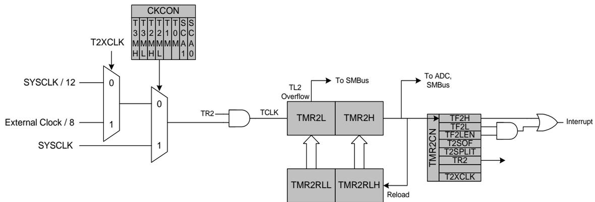
**Figure 19.4. Timer 2 16-Bit Mode Block Diagram**
