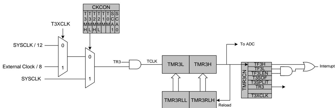
**Figure 19.8. Timer 3 16-Bit Mode Block Diagram**
