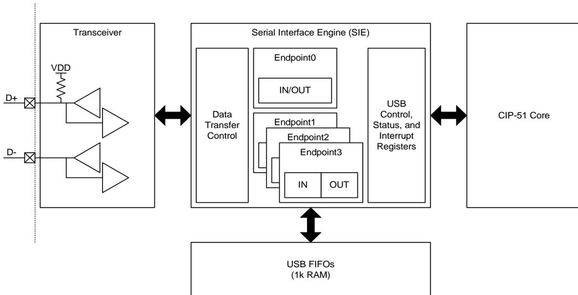
**Figure 15.1. USB0 Block Diagram**
