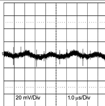
12 V<sub>IN</sub> 3.3 V<sub>O</sub> 3 A 20 mV/div 1 μs/div
