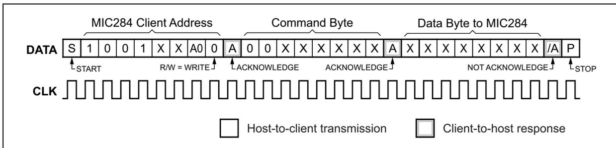
**FIGURE 3-1: WRITE\_BYTE Protocol.**
