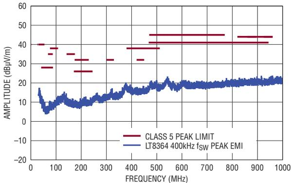
12V INPUT TO 24V OUTPUT AT 600mA, f<sub>SW</sub> = 400kHz
