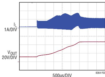
Figure 3. Soft-Start Waveforms
