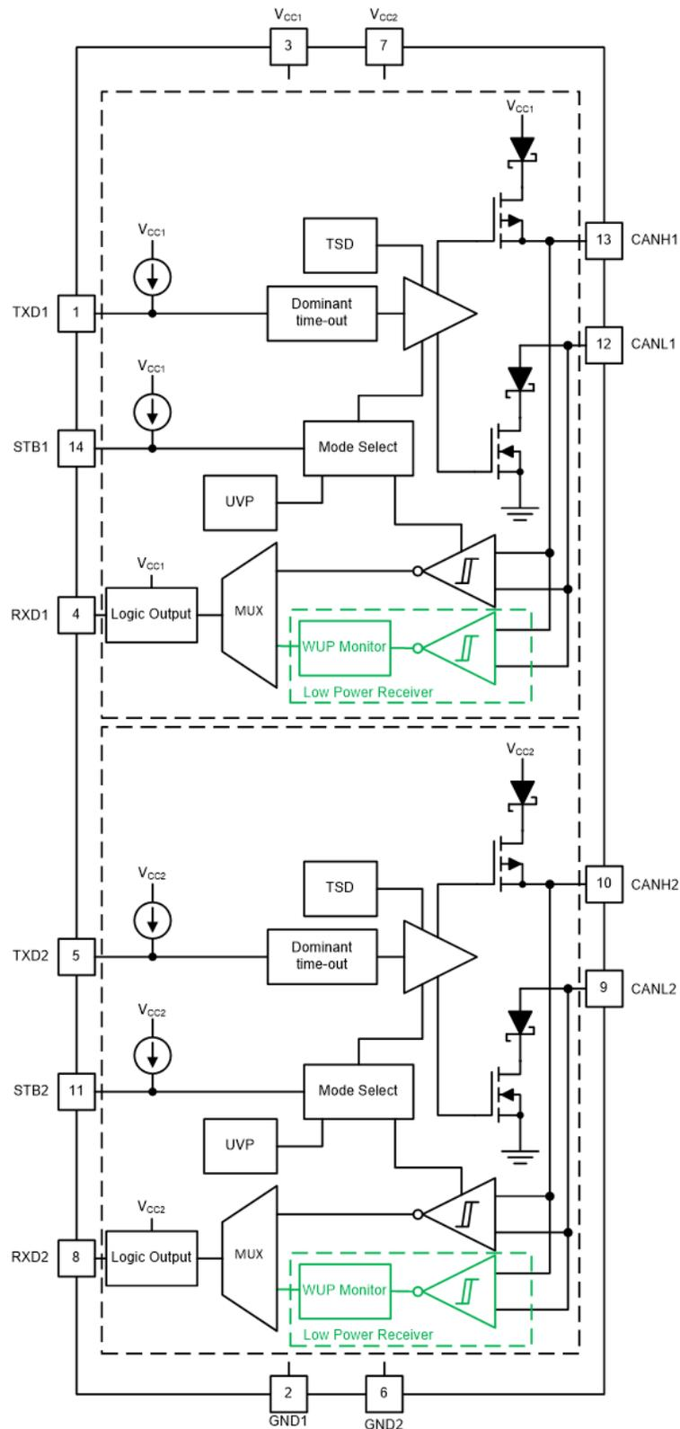
**Figure 8-1. Block Diagram**
