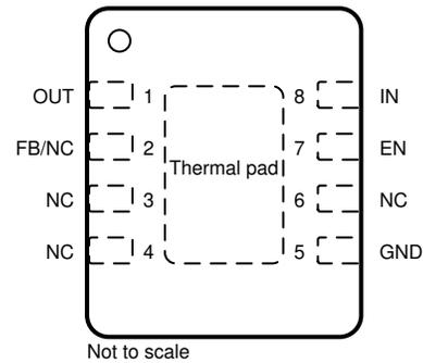
**Figure 5-2. DRB Package, 8-Pin VSON, Top View**
