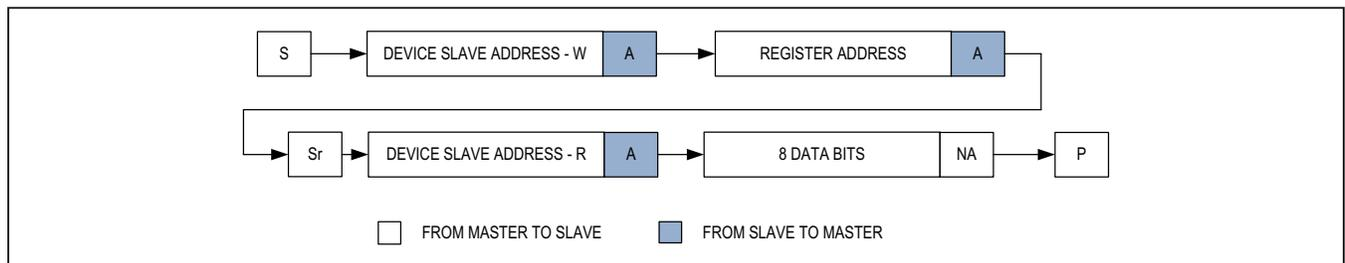
Figure 12. I<sup>2</sup>C Byte Read
