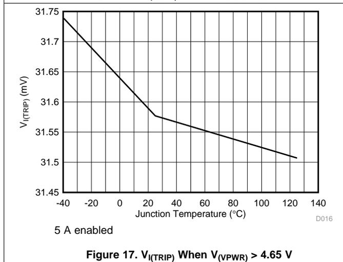
Figure 17.  $V_{(I(TRIP))}$  When  $V_{(VPWR)} > 4.65$  V
