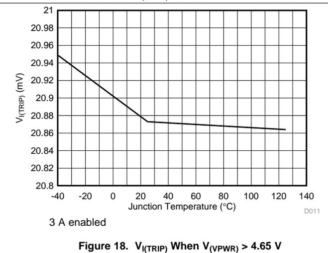
Figure 18.  $V_{(I(TRIP))}$  When  $V_{(VPWR)} > 4.65$  V
