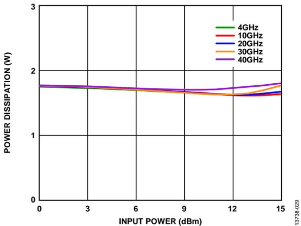
Figure 29. Power Dissipation
