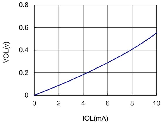
•  $V_{OL}$  vs.  $I_{OL}$  ( $\overline{INTR}$  pin) (Except R2051Txx)
