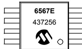
8-Lead SOIC (150 mil) (MCP6567)
