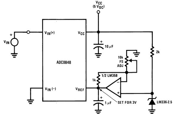
Figure 17. Span Adjust ( $0V \leq V_{IN} \leq 3V$ )
