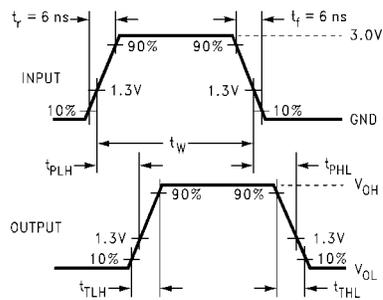
**FIGURE 3. AC Waveforms**
