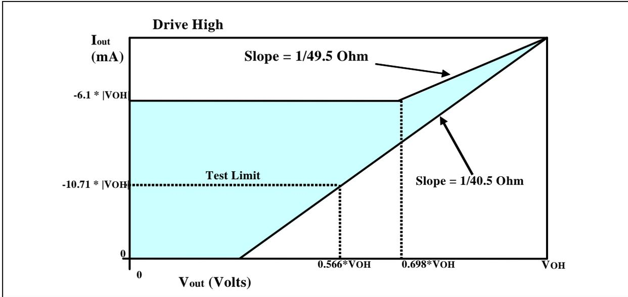
**FIGURE 6-2: FULL-SPEED DRIVER VOL/IOH CHARACTERISTICS FOR HIGH-SPEED CAPABLE TRANSCEIVER**
