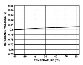
FIGURE 3. REFERENCE VOLTAGE VARIATION OVER TEMPERATURE
