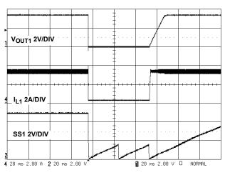
FIGURE 10. OVERCURRENT HICCUP MODE OPERATION
