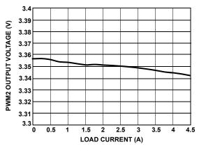
FIGURE 2. PWM2 LOAD REGULATION
