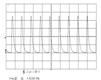
FIGURE 16. SYNC WAVEFORM
