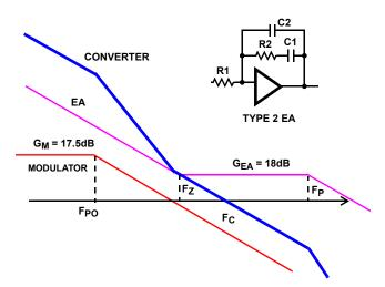
FIGURE 17. FEEDBACK LOOP COMPENSATION
