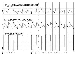
FIGURE 6. PWM2 WAVEFORMS
