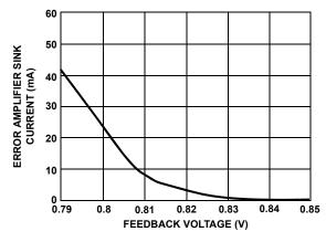
FIGURE 19. LINEAR CONTROLLER GAIN
