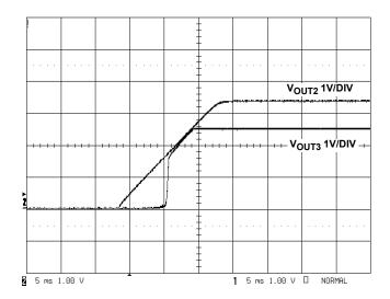
FIGURE 18. LINEAR REGULATOR STARTUP WAVEFORM
