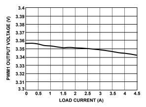
FIGURE 1. PWM1 LOAD REGULATION
