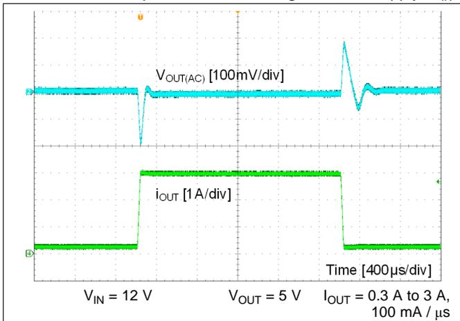
Figure 30. Load Transient
