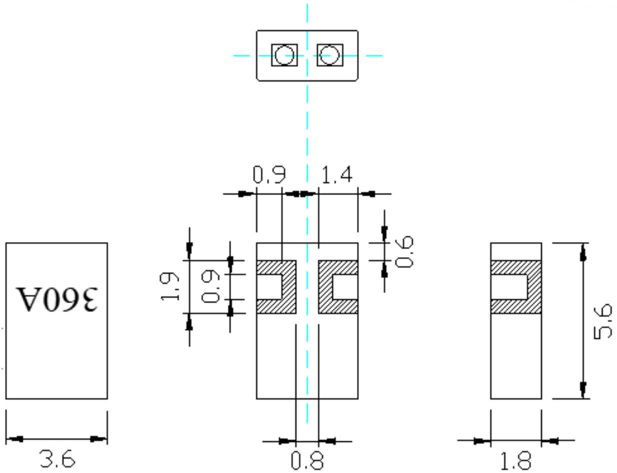
Tolerance:  $\pm 0.2\text{mm}$
