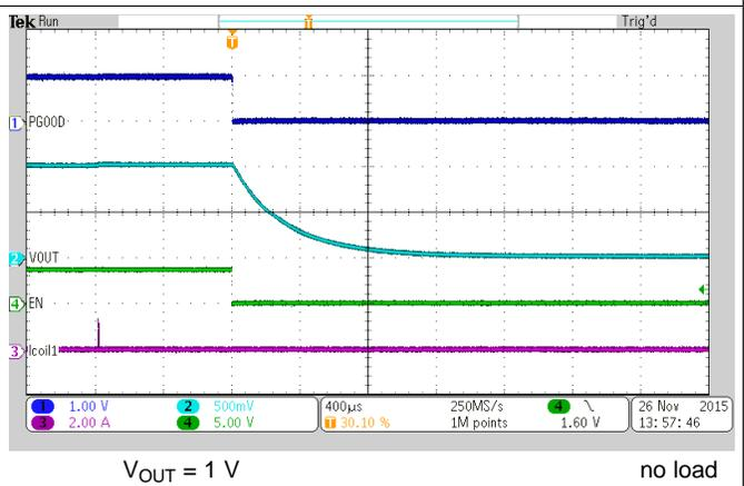
Figure 27. Output Discharge
