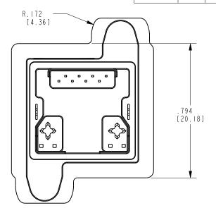
CONNECTOR MATERIALS: HOUSING/INSERT: THERMOPLASTIC UL94 V-0 SHIELD: ZINC DIE-CAST ALLOY SHIELD PLATING: TIN OVER COPPER CONTACTS: COPPER ALLOY
