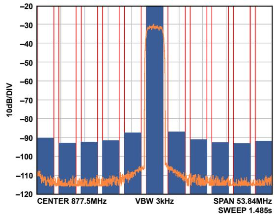
TOTAL CARRIER POWER  $-10.794\text{dBm}/3.84\text{MHz}$
