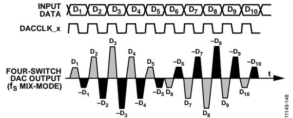
Figure 145. Mix-Mode Waveform
