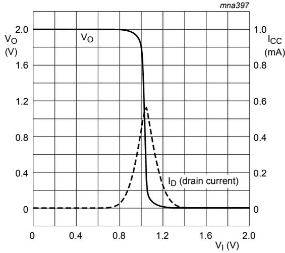
a.  $V_{CC} = 2.0\text{ V}; I_O = 0\text{ A}$
